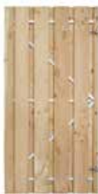
BRECHT DEUR MET STALEN FRAME - GESCHAAFD Lariks/douglas onbehandeld, RVS geschroefd. Inclusief cilinderslot, klink, duimen en verstelbare ogen. Links- en rechtsdraaiend. Planken: 1,6x14,5 cm 90x180 cm - 1003184
